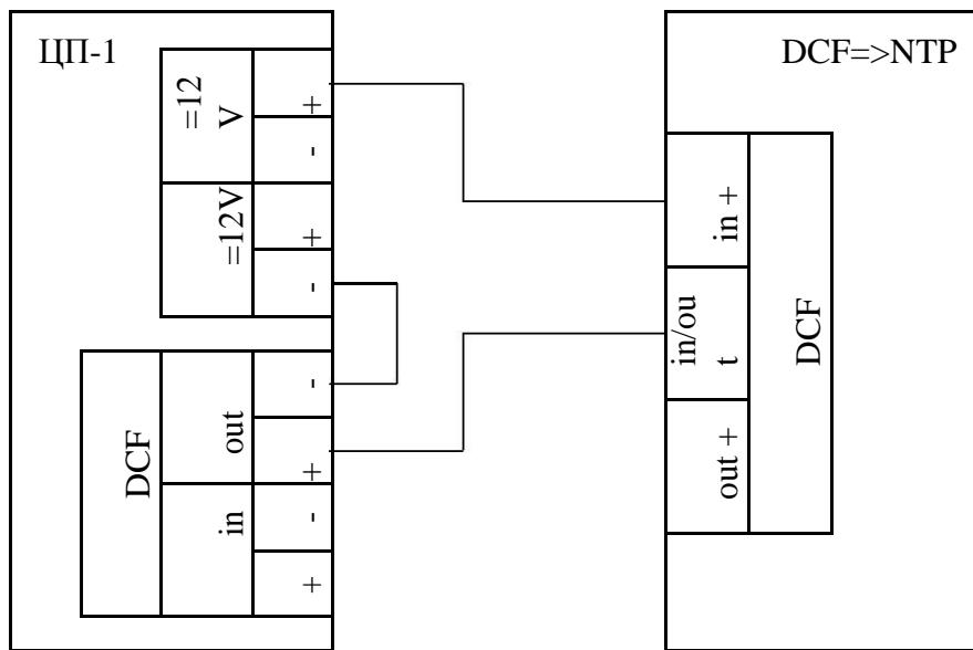
Схема подключения приёмника DCF-сигнала к конвертеру:
